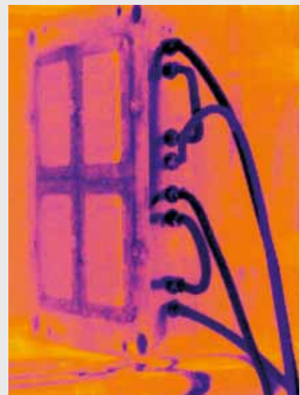
Distribución homogénea de la temperatura en la herramienta de colado por inyección, luego de la limpieza de los circuitos de templado.
